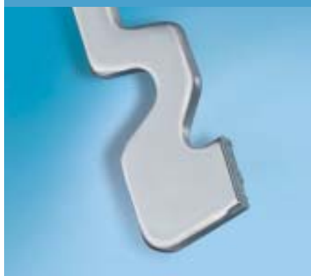
Gebrochener Nadelfuß mit Sollbruchkerbe
